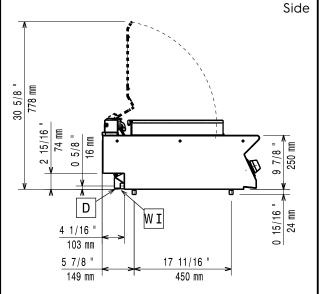
Drain Electrical inlet (power) EQ **Equipotential screw** Water inlet
